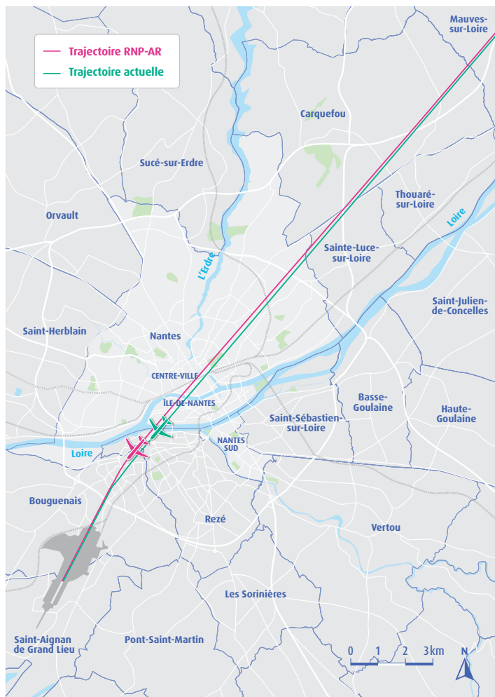
Comparaison entre la trajectoire actuelle et la trajectoire « RNP-AR »
